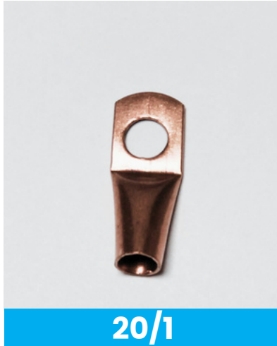
20/1 Terminal para cable de 25 mm aguj. de 10mm
