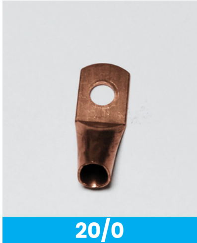
20/0 Terminal para cable de 25 mm aguj. de 8mm
